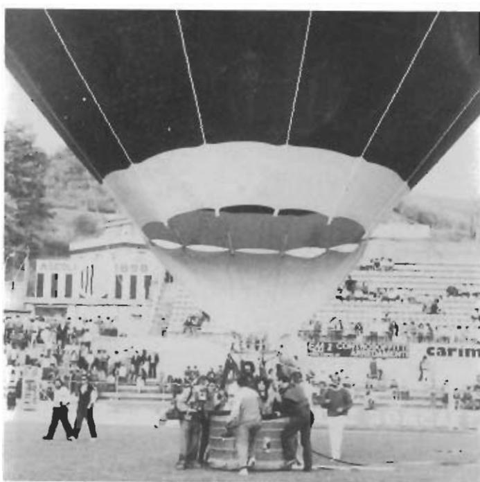
Sopra: La mongolfiera è già in posizione di volo. A fianco: Con due bruciatori alimentati da gas propauo si inmette aria calda nel pallone per permetterne l'ascensione.
