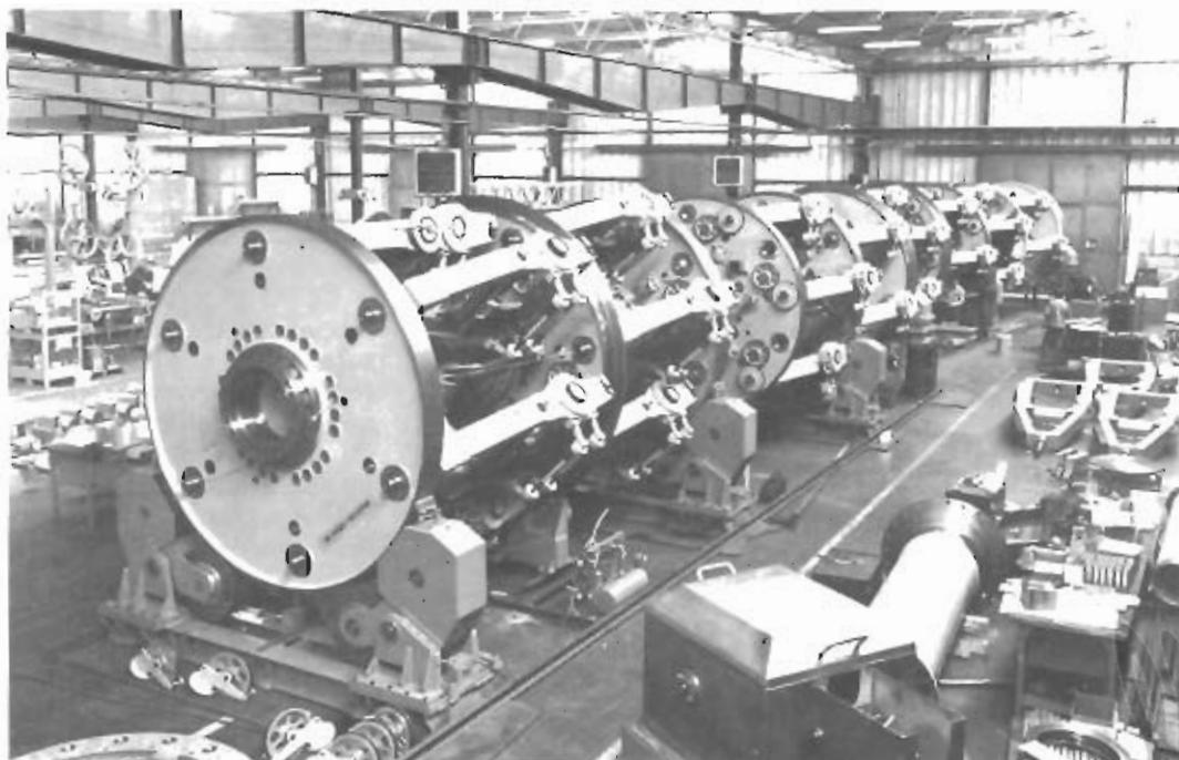
Armatrice per cavi telefonici sottomarini a fibre ottiche.
