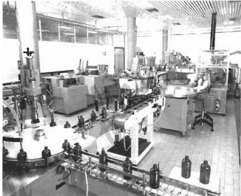
Zona confezionamento reagenti liquidi nei formati standard da 100 e 500 ml. Le linee sono completamente automatiche: dal posizionamento ordinato dei flaconi sulla linea di partenza alla cellofanatura delle confezioni.
