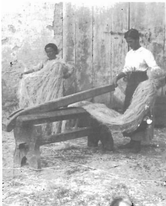
A fianco: la "rottura" o "macincolatura" eseguita a mano con la macingola. ■ Sopra: la scavezzatura della canapa effettuata, negli ultimi anni, a macchina.
