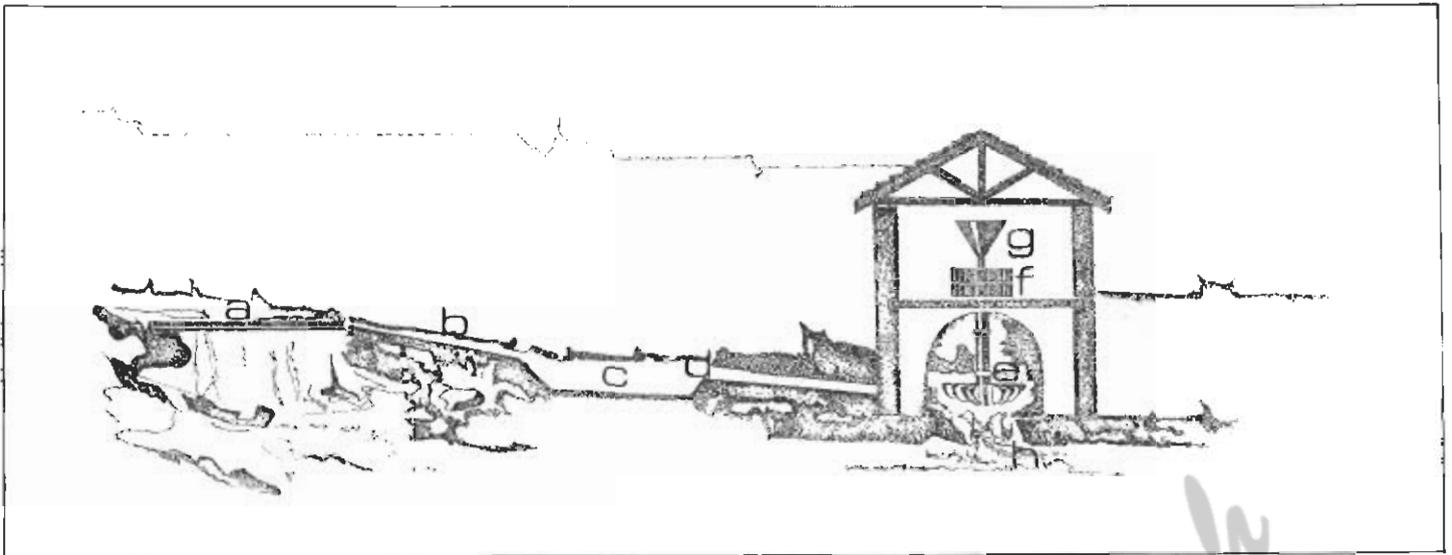
Spaccato di un vecchio mulino ad acqua. LEGGENDA: (a) sbarramento - (b) canale di derivazione - (c) bacino di raccolta - (d) condotta forzata - (e) ruota idraulica - (f) palmento mobile (macina) - (g) tramoggia - (h) scarico. Sotto: due caseggiati rustici ove sono ubicati mulini ad acqua.
