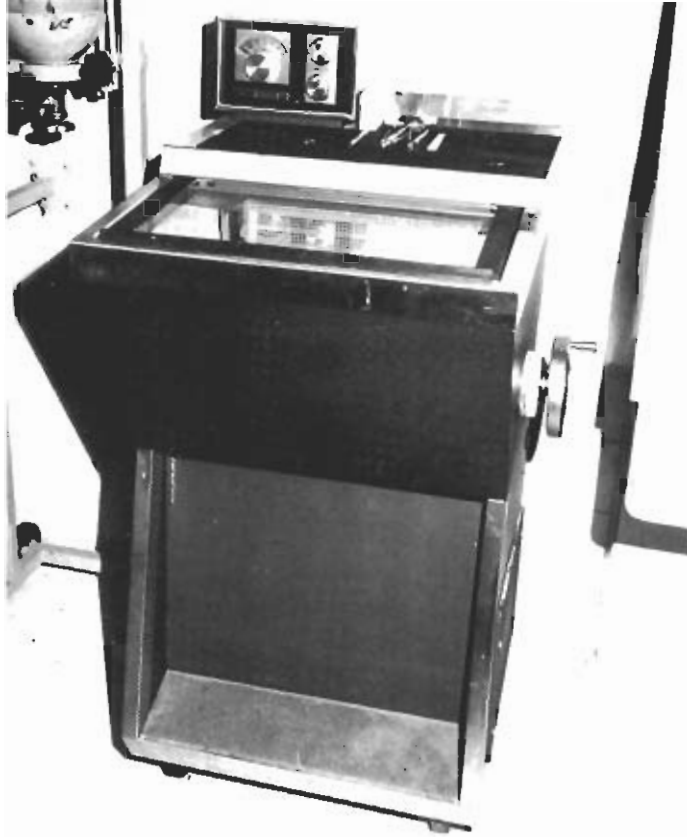
Criostato: strumento per il taglio di tessuti congelati operante a temperatura intorno a 30^{\circ}\text{C} , utilizzato nella diagnosi estemporanea intraoperatoria e per ricerche enzimatiche tissutali.
